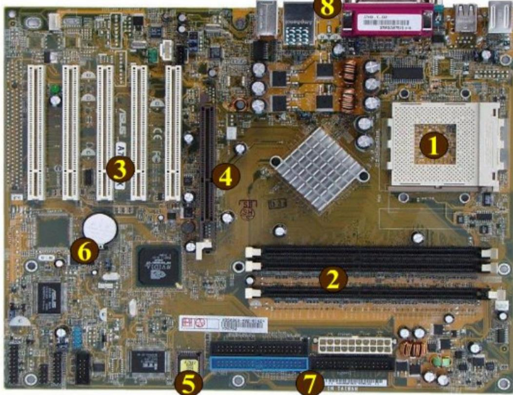
**5** Cette petite puce contient le BIOS (Basic Input/Output System), c.t.d, un petit programme qui s'exécute en premier lorsqu'on allume la machine et qui permet de la configurer.
