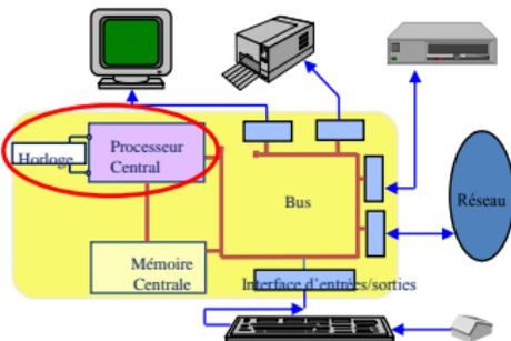
Le **processeur** (CPU, pour *Central Processing Unit*) est le cerveau de l'ordinateur. Il permet de manipuler, des données et des instructions codées sous forme binaires.
