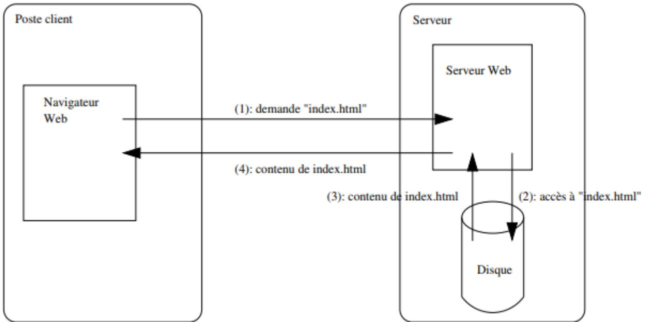
**Fig 2. fonctionnement des pages web statiques**
