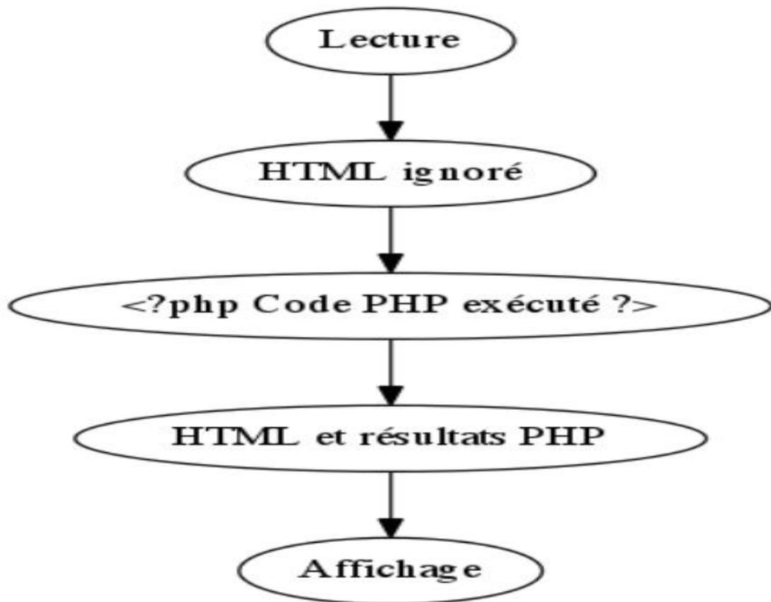
Fig 1. Fonctionnement de l'interpréteur
