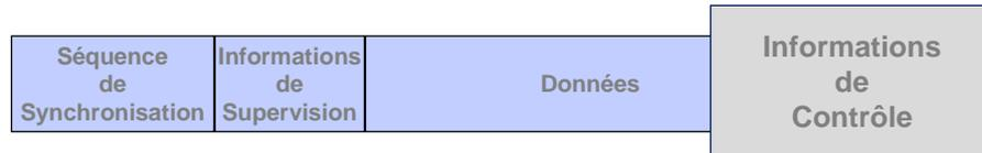
Généralement, une séquence binaire particulière, dont le contenu binaire est fonction des séquences binaires précédentes, permet au récepteur de vérifier la validité des informations reçues.
