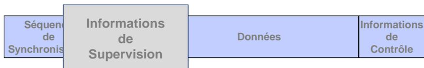
Généralement, dans les protocoles synchrones un champ est réservé à des informations de contrôle de l'échange de données entre les deux systèmes : ouverture de ligne, accusé de réception...
